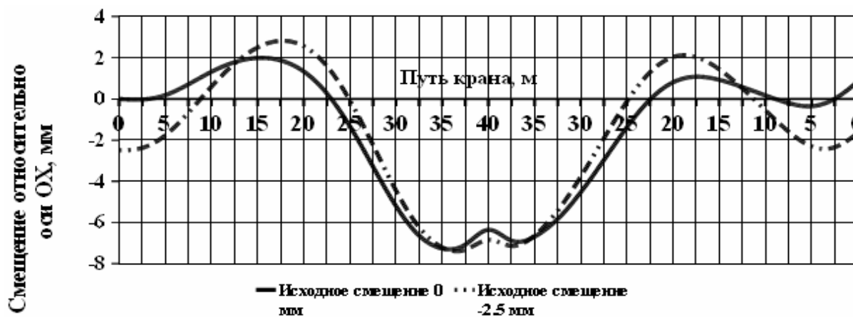
Рис. 3. Движение крана «вперед – назад» по криволинейным рельсам при длине волны свободных колебаний \approx 45 м
